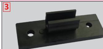
Clip di montaggio per lampadine PA66 Plastica, montaggio a 2 viti o adesivo, per lampadine di diametro 5 e 6 mm, temperatura massima 80°C
